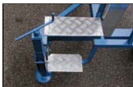
GRADINI DI ACCESSO ALLA PIATTAFORMA
